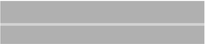
DETALHE I - MARCAÇÃO DE LINHA DE ESTACIONAMENTO LINHA SIMPLES CONTÍNUA BRANCA - LARGURA = 10 CM
