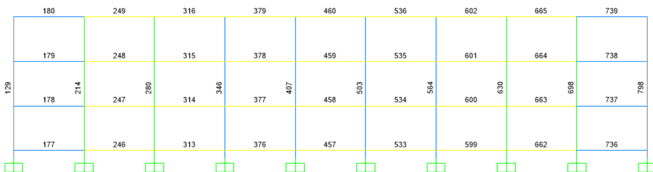
Figura 27 – Elevação terças de fechamento lateral – eixo A
