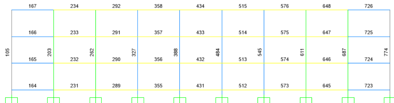
Figura 30 – Elevação terças de fechamento lateral – eixo F
