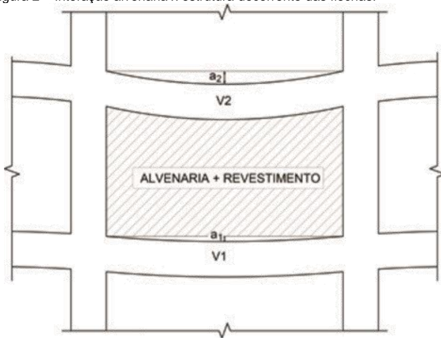
Figura 2 – Interação alvenaria x estrutura decorrente das flechas.
