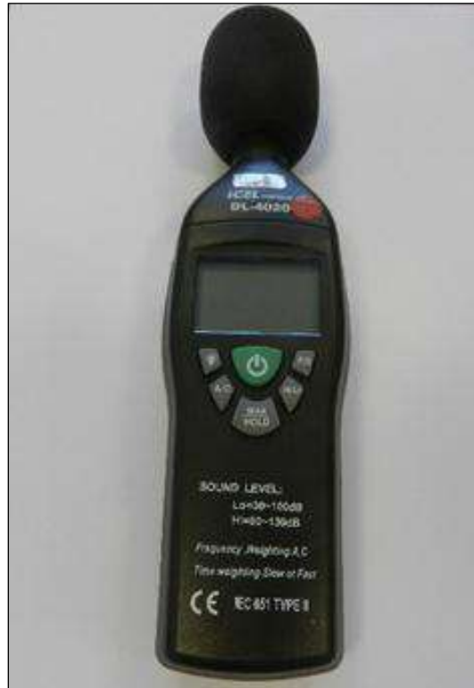
Figura 85: Medidor de pressão sonora utilizado durante as aferições.
