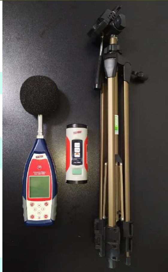
Figura 4: Equipamentos utilizados para medição de ruído (Sonômetro Instrutherm DEC – 7000, Calibrador Instrutherm modelo CAL-5000 e Tripé).
