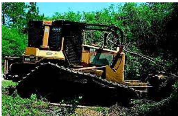
Foto 6-12: Trator florestal de esteira com equipamento de terraplanagem e cabine reforçada. Fonte: Google, 2020.
