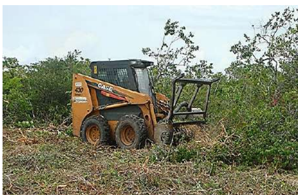
Foto 6-4: Desbastador florestal frontal acoplado à carregadeira compacta de direção.
