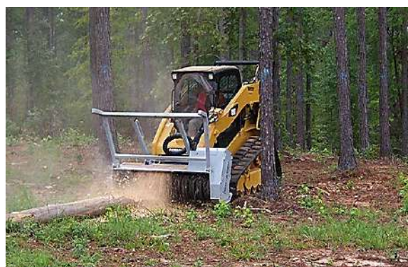
Foto 6-5: Desbastador florestal frontal acoplado à carregadeira compacta de esteira.
