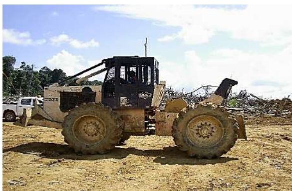
Foto 7-3: Skidder para arraste de toras. Fonte: Acervo Dossel 2009.
