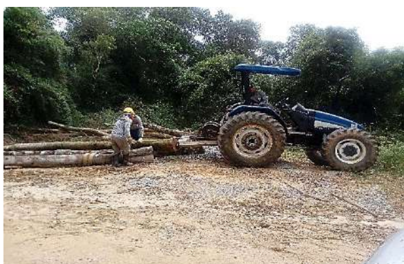
Foto 7-1: Arraste de toras utilizando trator agrícola. Fonte: Acervo Dossel 2019.
