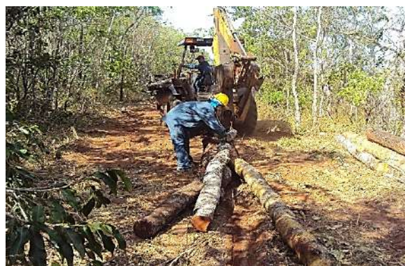
Foto 7-6: Arraste de toras utilizando retroescavadeira. Fonte: Acervo Dossel 2012.
