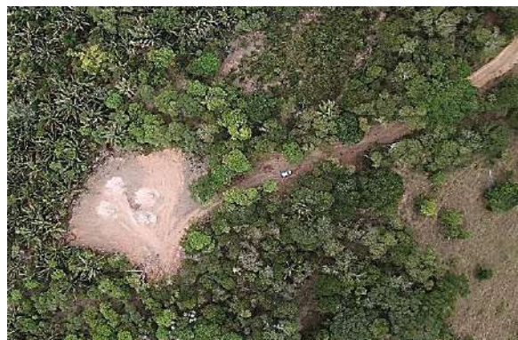
Foto 6-3: Exemplo de supressão na área de torre autoportante e acesso.
