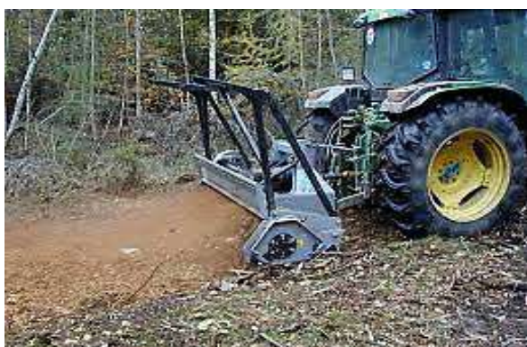
Foto 6-10: Desbastador florestal frontal acoplado à traseira de trator agrícola. Fonte: Google, 2020.
