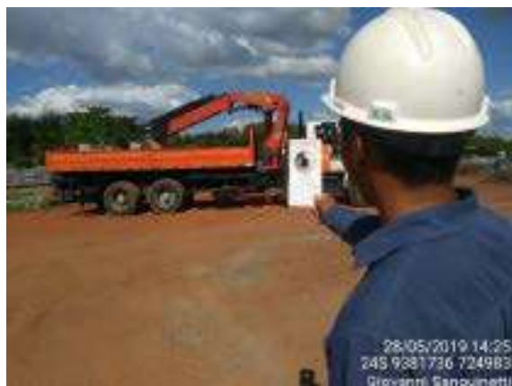
Foto 2-11: Monitoramento de fumaça preta utilizando Escala Ringelmann. Fonte: Acervo CYMI, 2019.
