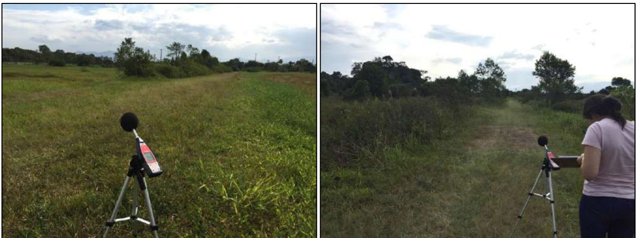
Figura 22: Avaliação do nível de pressão sonora no ponto 3 e 4 respectivamente, na área do empreendimento, registro em 05/05/2020.
