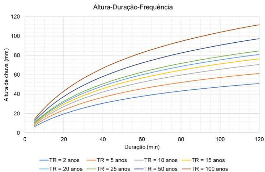
A intensidade de precipitação é o parâmetro mais relevante para o dimensionamento de sistemas de drenagem pluvial. Através desse valor são determinadas as vazões de projeto, ou seja, as vazões máximas que solicitarão a rede de drenagem considerando o tempo de retorno adotado em projeto.
