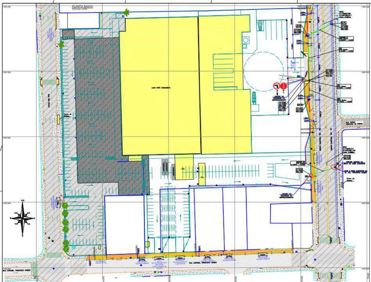
**Figura 4.17** - Projeto de acesso, com faixa de aceleração na Av. Procópio Gomes.
