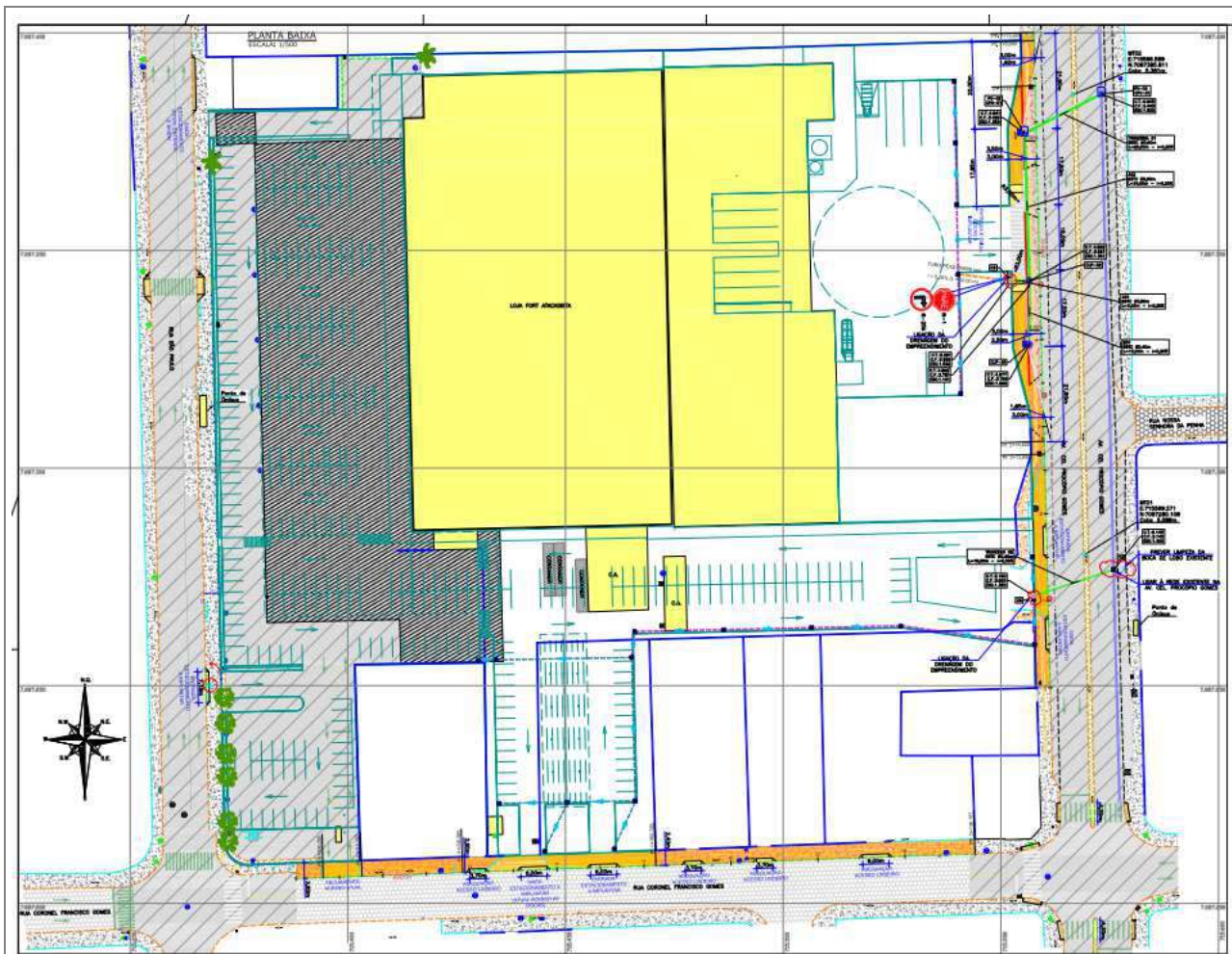
Figura 4.1 - Projeto em andamento de acesso, com faixa de aceleração na Av. Procópio Gomes.
