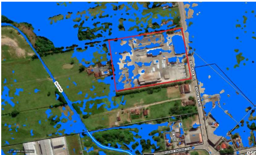
Figura 1. Mancha de Inundação
