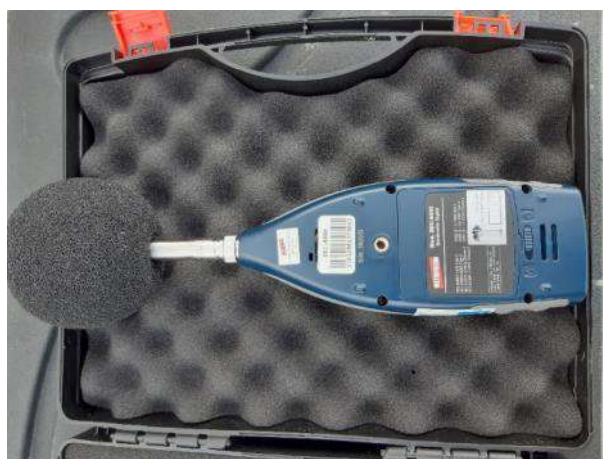
Foto 10-21: Detalhe do sonômetro (decibelímetro) modelo DEC 6000.
