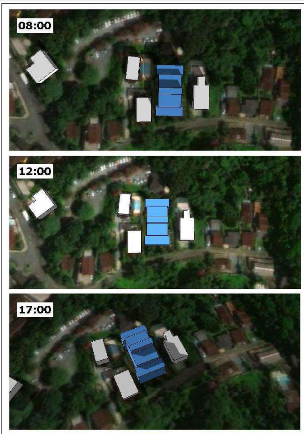
Figura 40. Simulação de insolação local no solstício de verão às 08:00, 12:00 e 17:00. Elaborado por Vitae Ambiental.
